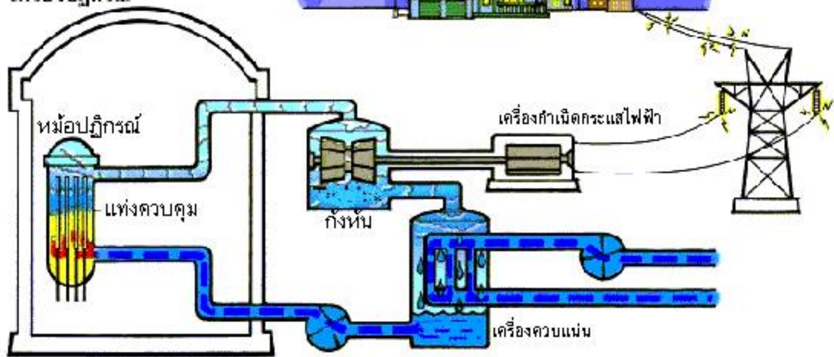
โรงไฟฟ้านิวเคลียร์แบบน้ำเดือด (Boiling Water Reactor : BWR)
